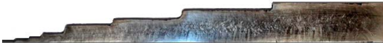
Рис. 1 – Макроструктура тела опытной модельной отливки
